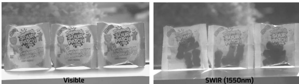
食品行业中加热密封包装的填充水平检查或检查密封完整性
